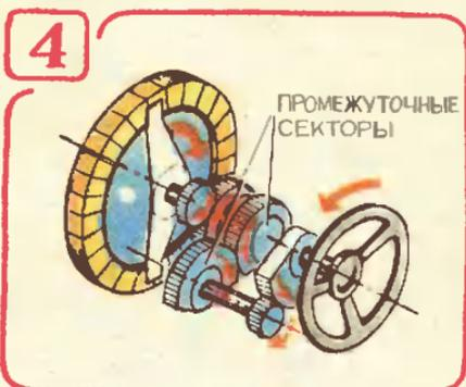
ла и против часовой стрелки. Изменение направления вращения в зубчатых передачах обычно достигается введением промежуточного колеса. В нашем случае для ограниченных углов поворота элементов механизма могут быть применены промежуточные секторы. Тогда наш механизм примет вид, показанный на рисунке 4. Но главная задача опять не решена, ибо стоит повернуть штурвал в другую сторону, как ползун двинется против часовой стрелки.
